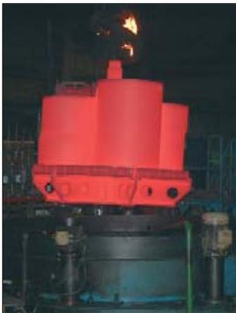
Mit Hilfe eines Krans wird ein großes erhitztes Werkstück zur Abkühlung in ein Ölbad transportiert. Foto: Tobias Krull
